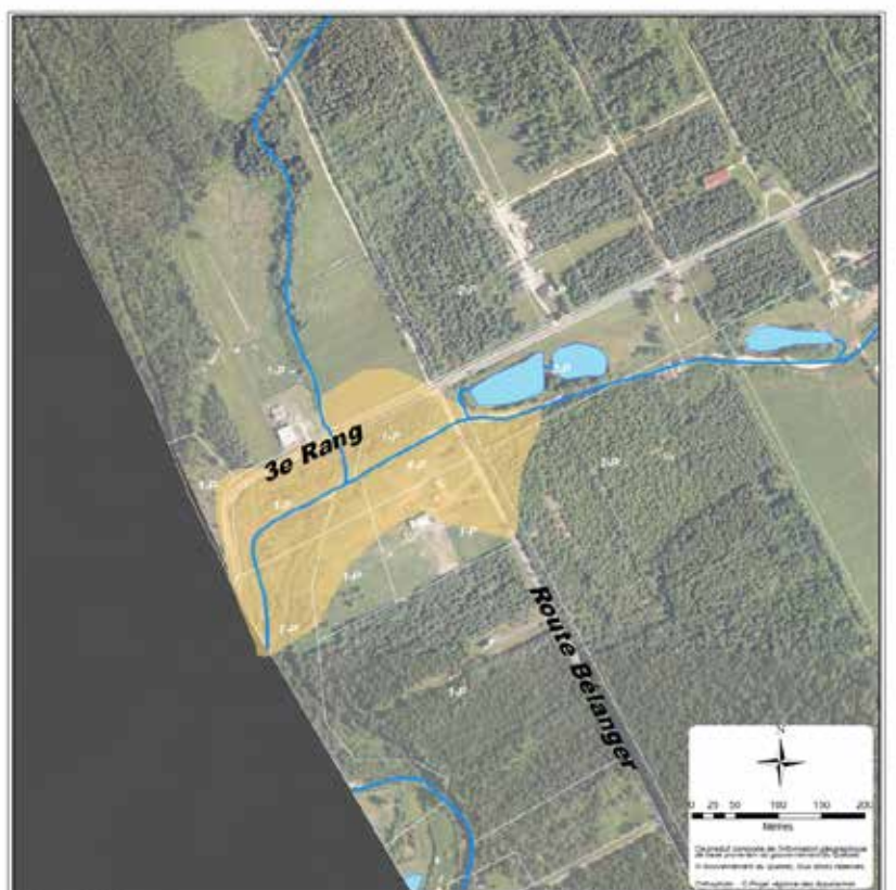
Carte 6.33 Risque d'inondation Cours d'eau: Rivière Melgarnette-Nord Municipalité: Saint-Zacharie
